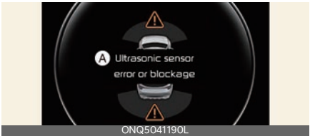
A: Fout of blokkering van de ultrasone sensor
